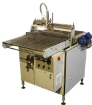
**1. УЗО-2** – автоматизированный узел опыления, предназначенный для нанесения клеевых составов, сиропов и прочих жидкостей на поверхность изделий, коржей и прочего. Машина изготавливается под конкретное техническое задание заказчика и может иметь огромное количество опций и модификаций. Например:
