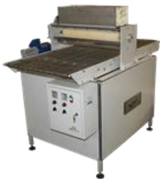
**2. МП-600** – машина посыпки предназначенная для декорирования верхней поверхности кондитерских изделий (сахарное печенье, крекер, сушка, кондитерские пласты и т.д.) сыпучей фракцией (сахар, мак, кунжут и т.д.). Машина используется в составе поточных линий формовки и выпечки печенья.
