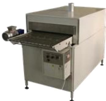
**3. МСТ-2** – машина сушки тоннельного типа предназначена для фиксации и сушки изделий после обработки клеевыми и другими специальными составами. Машина изготавливается под конкретное техническое задание заказчика и может иметь огромное количество опций и модификаций.
